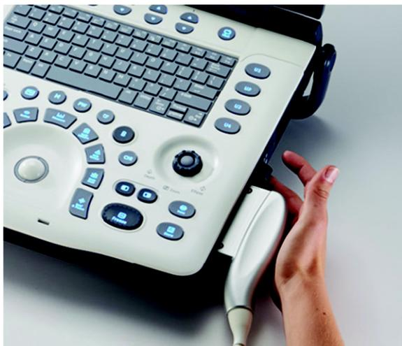
Allineare il connettore alla porta della sonda e spingere delicatamente il connettore in posizione, con il cavo rivolto verso la parte anteriore del sistema. Quindi, spostare la leva di blocco del connettore verso l'alto.
