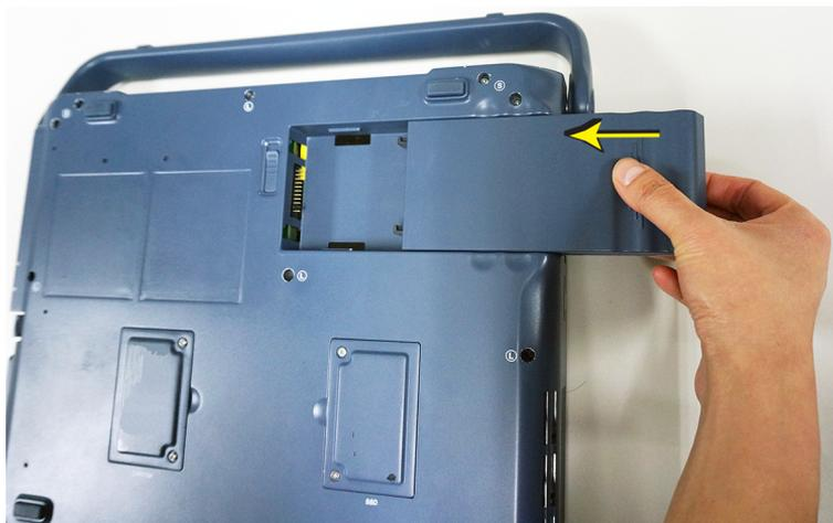
Illustrazione 1-13. Posizionamento della batteria sulla calotta inferiore
