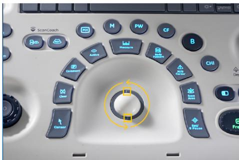
**Ruotare** l'anello di fissaggio in **senso antiorario** in modo che sia possibile rimuovere la trackball dalla relativa scanalatura.
