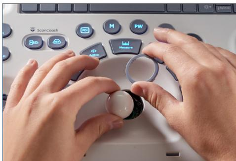
Estrarre la trackball, asciugare eventuali tracce di olio e polvere dalla trackball, dall'anello di fissaggio e dell'alloggiamento della trackball utilizzando un tampone di cotone o altro agente detergente. Posizionare la trackball nell'alloggiamento e montare l'anello di fissaggio nella scanalatura, **ruotare** in senso orario fino a quando le tacche non sono in posizione.
