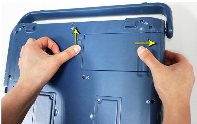
Illustrazione 1-15. Sblocco e spinta della batteria
