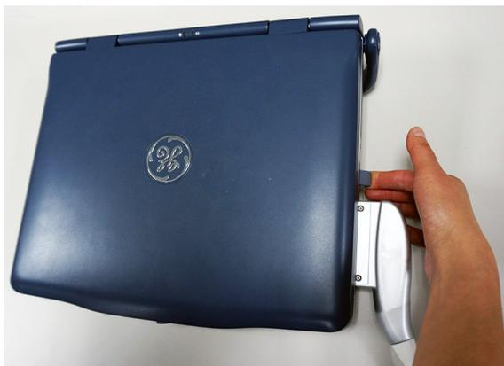
Illustrazione 1-36. Leva di blocco connettore sonda
