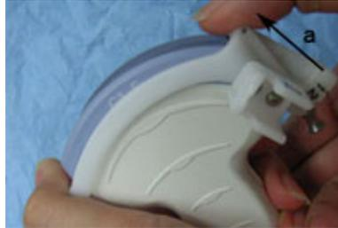
Illustrazione 5-18. Rimozione della guida per biopsia
