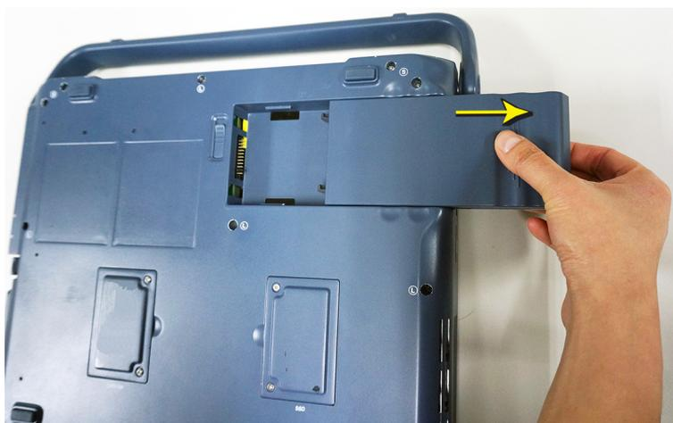
Illustrazione 1-16. Rimozione della batteria
