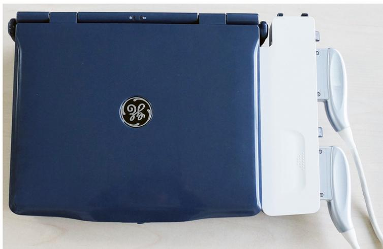
Illustrazione 1-41. Collegamento dell'adattatore per 2 sonde, Passaggio 5
