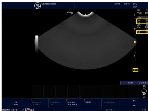
La sonda E8C è stata selezionata. Il preset definito dal produttore per la frequenza è 10 MHz, per la profondità è 8 cm, per il guadagno è 56 e per la gamma dinamica è 69.
